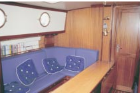
Vor dem L-Sofa an Backbord ist der Kielkasten eingebaut, der als Tisch-mittelteil fungiert.
