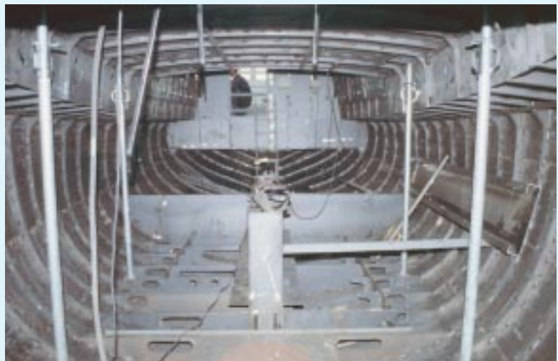
Die Puffin wird auf eng gesetzten Spanten und hohen Bodenwrangen beplattet.
