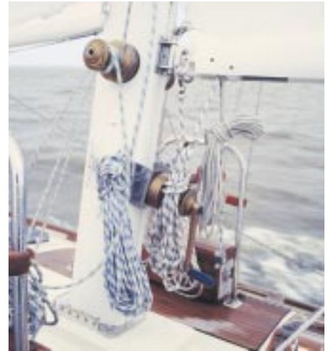
Bronzewinschen dienen zum Setzen und Reffen der Segel.
