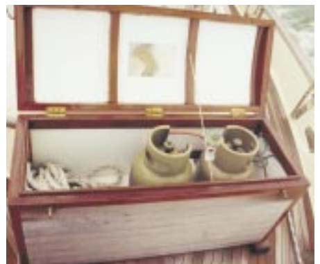
Die Gaskiste auf dem Vorschiff ist zwar schön gearbeitet, nimmt aber auch reichlich Platz weg.
