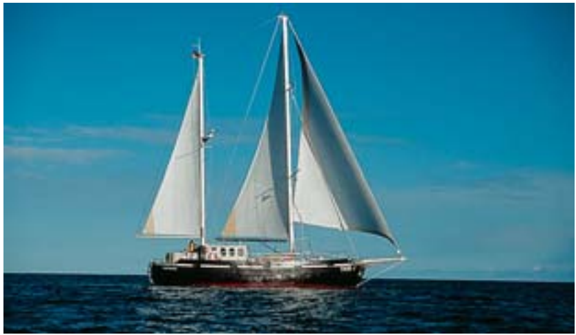
Die modernen Rollsegel auf dem traditionellen Schiff machen es einhandauglich
