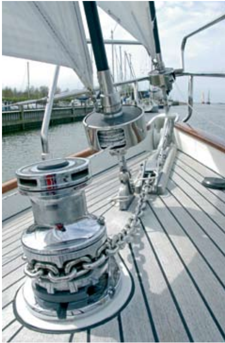
Beide Vorsegel des Testschiffs sind mit Rollreiffanlagen ausgestattet. Die Ankerkette läuft vom Spill über eine Führung in einen abgeschlossenen Kasten
